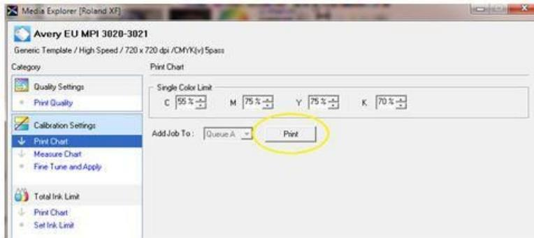
6. Wählen Sie nach dem Drucken 'Measure Chart' im Menü und klicken Sie 'Calibrate', um Ihr Gerät zu kalibrieren.
