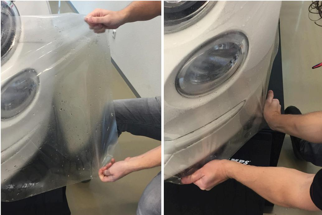
Konventionelle konvexe Formen und Formteile an Fahrzeugfronten eignen sich meist für die Verklebung mit allen Lackschutzfolien der Avery Dennison SPF-Serie. Bei stärker gewölbten Formen kann es jedoch erforderlich sein, einen Einschnitt vorzunehmen, um jeglichen Luft-/Wassereinschluss in den tiefen Rillen zu vermeiden. Dieser Einschnitt beeinträchtigt nicht die Funktionalität oder Haltbarkeit des Produkts.
