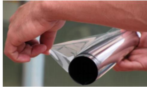
**Schritt 3 - Schneiden Sie die Folie zu:** Schneiden Sie die Folie vorab auf Fenstergröße zu und achten Sie auf eine Überlappung von 2 cm an allen vier Seiten: Arbeiten Sie direkt von der Rolle und schneiden Sie sie auf der beschichteten Seite mit einer OLFA® Klinge zu. Bei der aufgerollten Folie muss die Seite des Trägermaterials nach außen, die beschichtete Seite nach innen zeigen.
