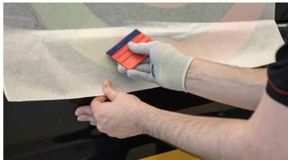
Usando Paper 300- High Tack par aplicar material reflectante impreso de rotulación V-400
