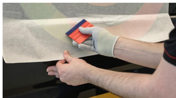
Transfert de films rétro-réfléchissants imprimés V-4000 avec l'Application Paper 300 - High Tack
