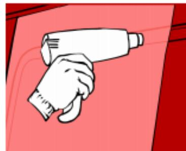
7. Ahora, empiece a estirar el material para adaptarlo a la ondulación, comenzando por la parte más profunda (la parte en la que el material vaya a requerir el mayor estiramiento, como puede ser una esquina). Asegúrese de que el material se caliente para mantenerse a una temperatura de entre 40° y 50°.
