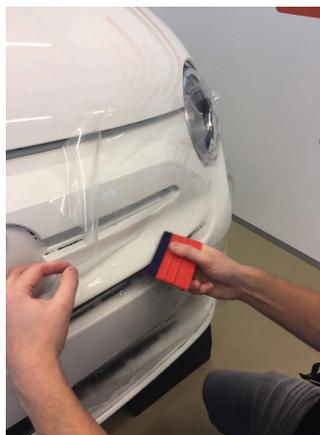
Pour les surfaces courbes, il est nécessaire de tirer fermement et d'étirer le film afin qu'il épouse les formes des surfaces. Le repérage de quelques points de fixation, sur lesquels l'adhésif peut être activé en appliquant une pression, facilitera le processus d'étirage et de mise en place. Il est recommandé d'étirer le matériau sans appliquer de chaleur, en utilisant la flexibilité
