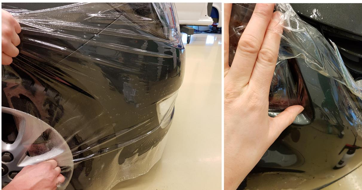
Le film Avery Dennison Pure Defense PU présente un bon degré de conformabilité. Par conséquent, il convient généralement pour recouvrir les formes conventionnelles convexes et composées de l'avant des voitures. Néanmoins, dans les formes aux ondulations profondes, il peut être nécessaire de pratiquer une incision afin d'éviter toute forme de piégeage d'air/eau
