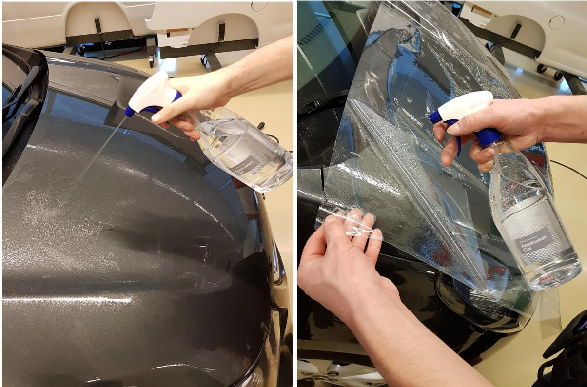
Retirez le support dorsal et pulvérisez le côté adhésif exposé avec la solution savonneuse. Positionnez ensuite le matériau sur la zone de pose sélectionnée. Au besoin, faites glisser le
