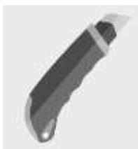
Utilisez un cutter tranchant pour découper une petite forme de maillage hachuré au centre du film (en prenant soin de ne pas marquer le substrat), divisez la petite zone en 10 carrés relativement égaux, comme dans le diagramme :
