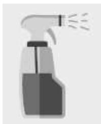
Vaporiser la surface résistante aux rayures du film avec la solution de mouillage (voir ci-dessous), afin que la raclette glisse doucement et uniformément sur la surface du film.
