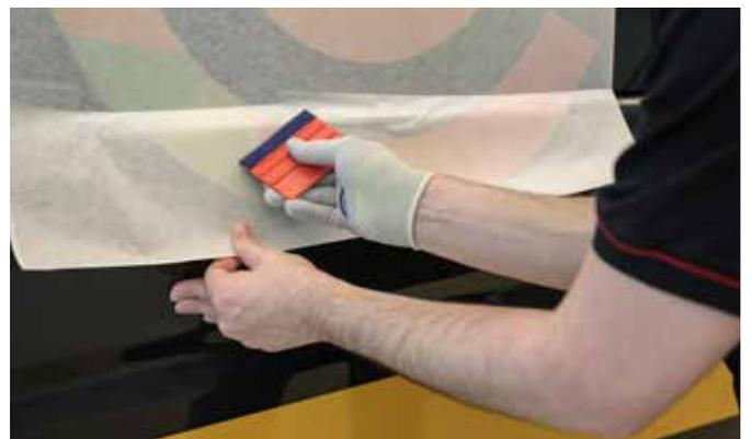
Transfert de films rétro-réfléchissants imprimés V-4000 avec l'Application Paper 300 - High Tack
